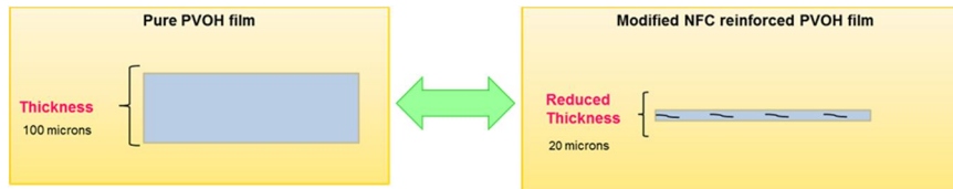
Kuva 18. Ohuemman PVOH-kalvon valmistaminen kemiallisesti muokatus selluloosananofibrillilisäyksen avulla [36].
