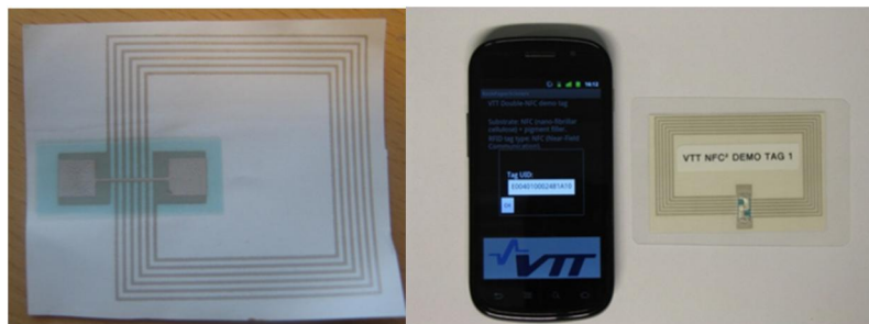
Kuva 22. Täyteaine-CNF-alustalle painettua elektroniikkaa. Vasemmalla LC-värähtelijä ja oikealla RFID-tunniste, joka on kuumalaminoitu muovitaskun sisälle. RFID-tunnisteen sisällön voi lukea matkapuhelimella [111,112].
