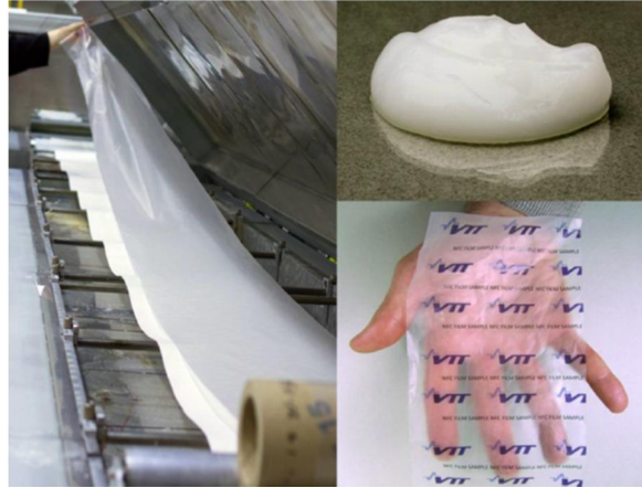
Kuva 21. Selluloosananofibrillikalvon valmistus rullalta rullalle VTT:n pilotmittakaavan Sutco-laitteella [36].
