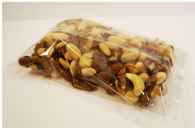
Kuva 20. Läpinäkyvää PET/CNF/LDPE-kalvoa voidaan käyttää kuivien elintarvikkeiden, kuten pähkinöiden, kuivattujen hedelmien ja mausteiden, pakkaamiseen (kuvan lähde: VTT).
