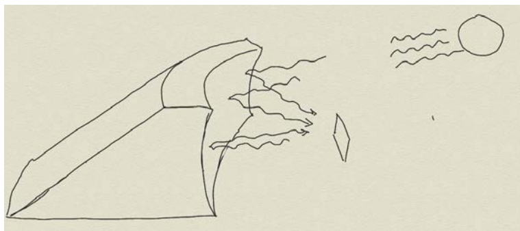
Kuva 16. Periaatekuva koneellisesti muotoillusta lumiheijasteesta (heijastekalvo pinnalla) ohjaamassa matalalta paistavan auringon säteilyn aurinkopaneeliin.
