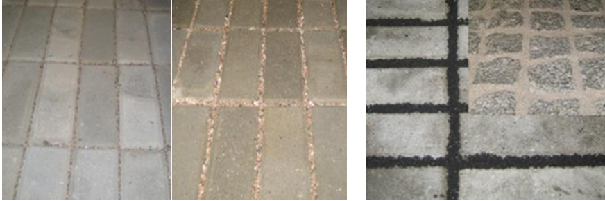
Kuva 8. Vettä läpäiseviä betoni- ja luonnonkivipintoja: a) Saumamateriaalina vettä läpäisevä kiviaines (VTT laboratorio); b) Sidottu saumamateriaali betoni- ja nopakivien saumamateriaalina (VTT laboratorio).
