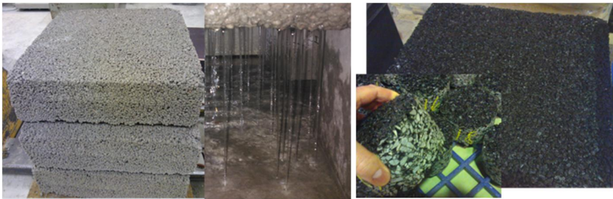
Kuva 9. Läpäisevä betoni (VTT laboratorio) ja avoin asfaltti (Lemminkäinen Oy).
