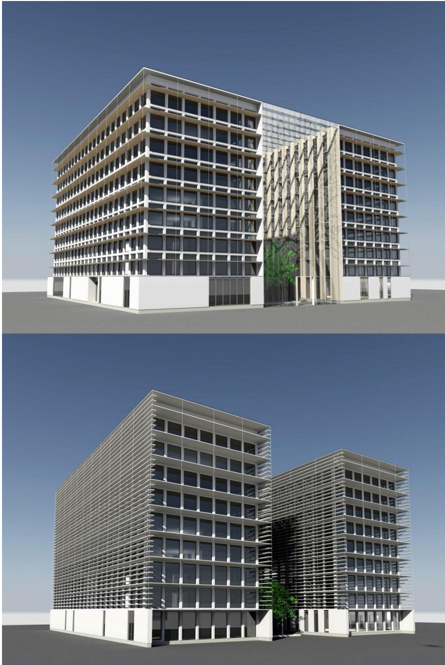
Kuva 14 Ylemmässä kuvassa varjostava vaakarakenne ja valohylly. Alemmassa kuvassa eteläjulkisivun ikkunoiden varjostus vaakarakenteella; itä- ja länsijulkisivun varjostus vaakasäleiköllä.
