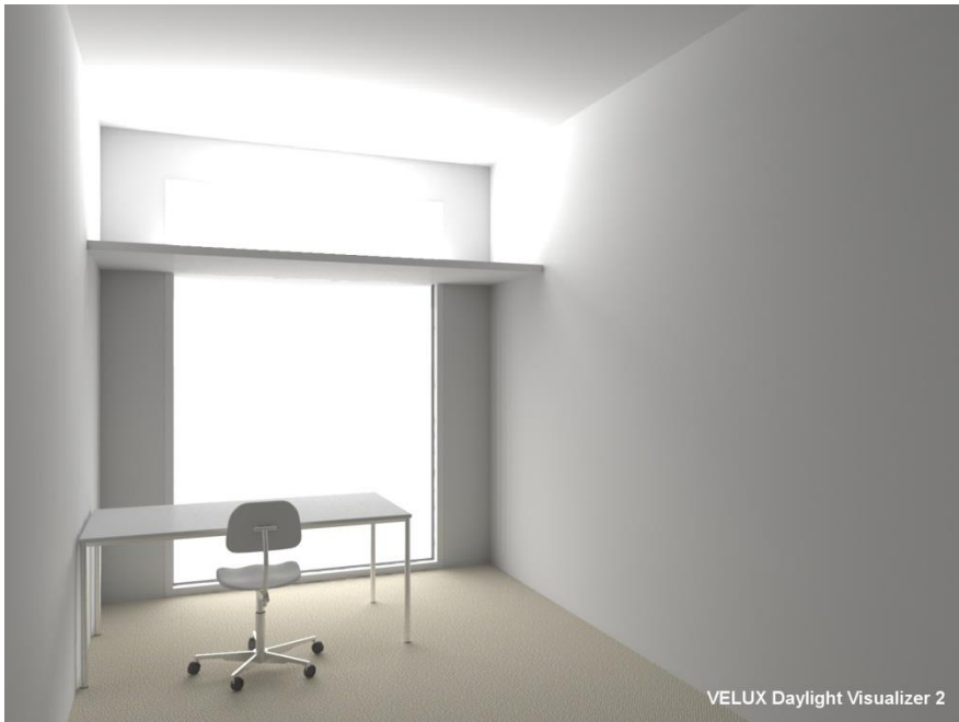
Kuva 16. Valohylly etelään suunnatussa toimistohuoneessa, aurinkoinen päivä.
