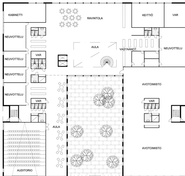
Kuva 12. Esimerkki SunZEB-konseptiin soveltuvasta toimistotalosta, pohjakerroksen pohjapiirustus.
