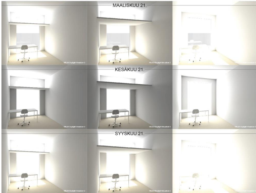
Kuva 17. Vasemmalla varjostava vaakarakenne ja 900 mm syvä valohylly; keskellä varjostava vaakarakenne ja 2100 mm syvä valohylly; oikealla varjostavat vaakarakenteet välipohjien kohdilla. Tarkastelussa etelään suunnattu toimistohuone; aurinkoinen päivä maaliskuussa, kesäkuussa ja syyskuussa.
