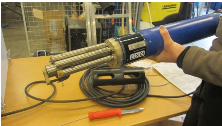
Kuva 37. EXO2-mittalaite, joka koostuu sameus-, fDOM- ja pH-antureista.
