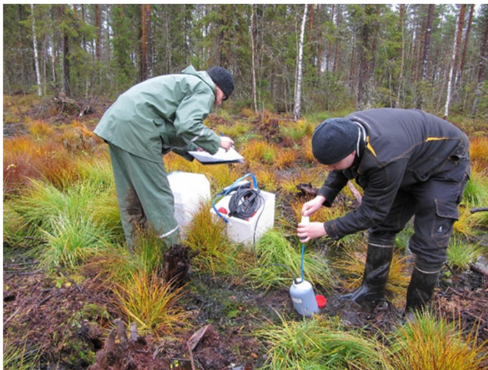
Kuva 36. Pintavalutuskentältä otettiin vesinäytteitä yhteensä 12 koepisteestä. Vesinäytteiden pH ja johtokyky mitattiin heti näytteenoton jälkeen kannettavalla mittalaitteella.
