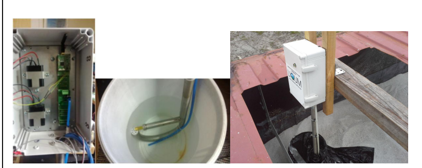
Kuva 47. Kenttämittauslaitteisto. Vasemmalla sähkökaappi, keskellä mittapää, jossa 1 mittauselektrodi ja erillinen referenssielektrodi sekä oikealla mittaripaketti asennettuna hiekkasuotimeen.
