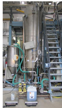
Kuva 10. Dynaaminen hiekkasuodatin osana humusveden puhdistusprosessia.
