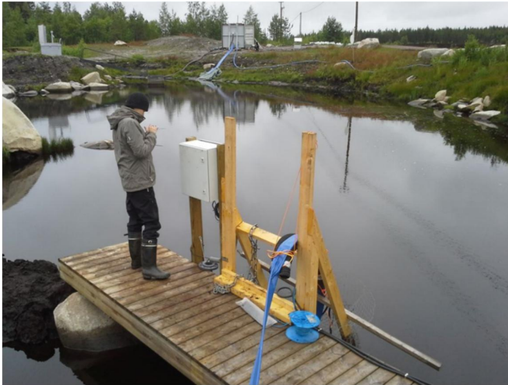
Kuva 40. Puhdistettava vesi pumpattiin konttiin (kuvassa taka-alalla) pumpppausaltaasta, josta otettiin konttiin tulevan veden vesinäytteet sekä mitattiin vedenlaatua myös jatkuvatoimisesti.
