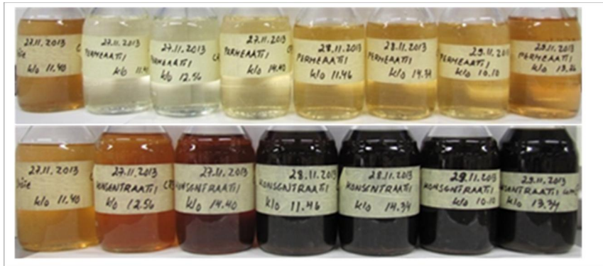
Kuva 33. Konsentraatio 1/200 (700 l:sta 3,5 l:aan) tehtiin CR suotimella käyttäen mikrosuodatuskalvoa. Yllä konsentraatti ja alla permeaatti.
