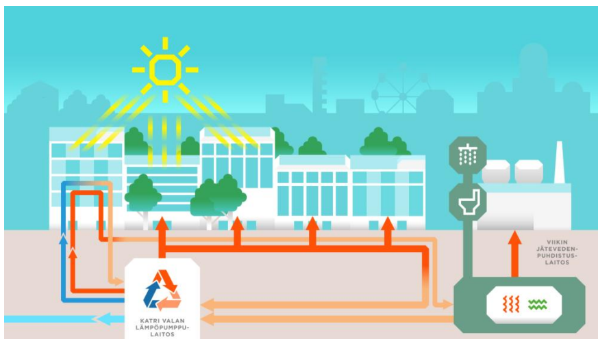
Kuva 10. Yhdistetty kaukolämmitys (lämmin käyttövesi rakennuksiin) ja kaukojäähdytys kesätilanteessa, mukana aurinkolämmön talteenotto (Helen Oy, 2015).
