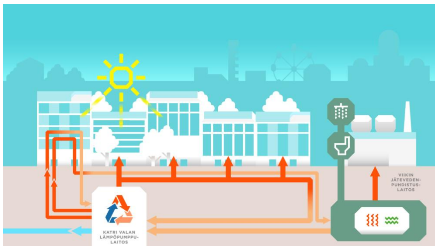
Kuva 11. Yhdistetty kaukolämmitys ja -jäähdytys talvitalanteessa, mukana aurinkolämmön talteenotto rakennuksista. Helenillä on tutkimushanke käynnistymässä, ja tavoitteena on tuottaa tällainen tyyppirakennus v. 2018–2022. (Helen Oy, 2015.)
