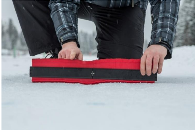
Kuva 18. Uraprofiilin muoto jäljennettiin 500 mm pituisen muotokamman avulla. Parhaiten muoto jäljentyi, kun kamman piikit "taputeltiin" päältä päin pintaan kiinni. Lumipolanne oli sen verran kovaa, että oikein käytettynä piikit eivät painuneet polanteen sisään.
