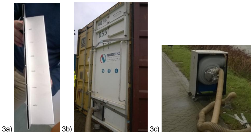
Kuvat 3 a–c. a) Tuuletuksessa käytetty suulake, b) käytetty irto-ovi, c) käytetty tuuletinmalli.
