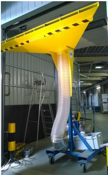
Kuva 5. Konttien tuulettamiseen suunniteltu ja testeissä käytetty keskipakopuhallin.
