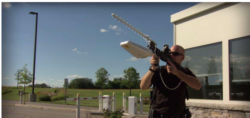
Kuva 14. Lennokkien torjuntaan kehitetty DroneDefender-radiohäirintälaitte. Sillä on kyky häiritä sekä kommunikointia että paikannusta. (Terndrup 2015.)
