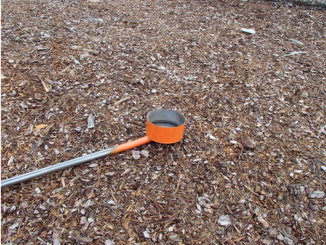
Kuva 3.2. Pitkävartinen kolmen litran näytteenottokauha, joka sopii metsähakkeen näytteenottoon. Kuva: Ismo Tiihonen.
