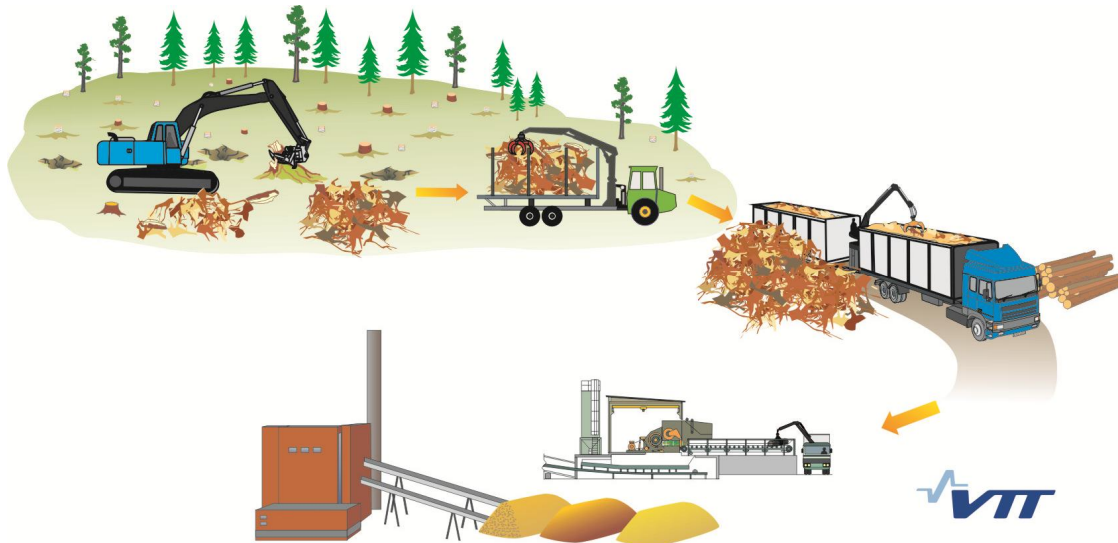
Kuva 4.13. Kantojen korjuu energian tuotantoon, murskaus käyttöpaikalla. Kuva: VTT.
