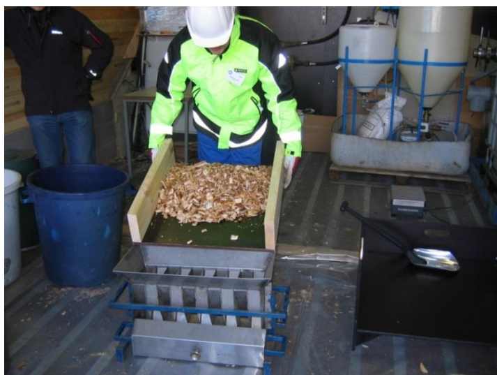
Kuva 3.7. Hakenäytteen jakaminen lokerojakajalla. Kuva: Eija Alakangas, VTT.
