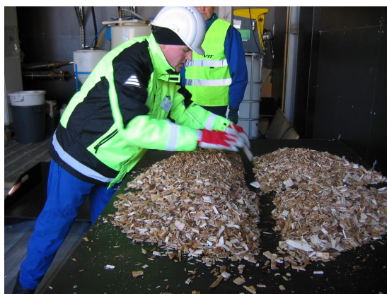
Kuva 3.8. Näytteen jakaminen neliointimenetelmällä. Kuvat: Eija Alakangas, VTT.
