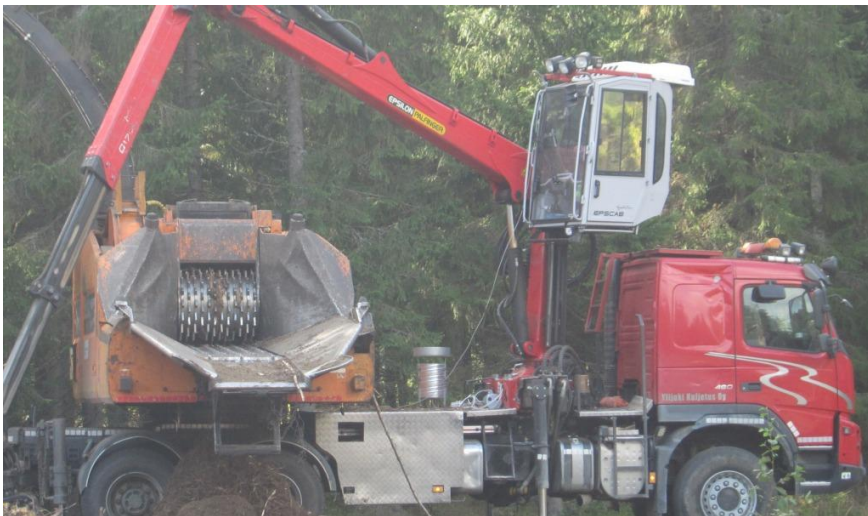
Kuva 15. Koelaitteisto asennettuna haketusajoneuvon rungon päälle.
