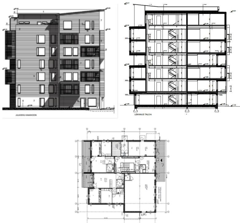
Kuva 30. Eskolantien puukerrostalon julkisivu, leikkaus ja pohjaratkaisu.
