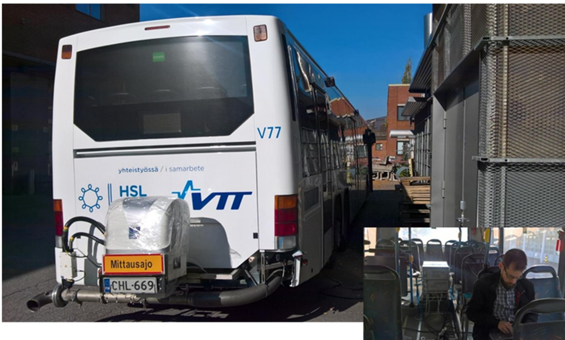
Kuva 2.20. VTT:n omaan, HSL:n väreihin maalattuun bussiin asennettu PEMS-mittalaitteisto.
