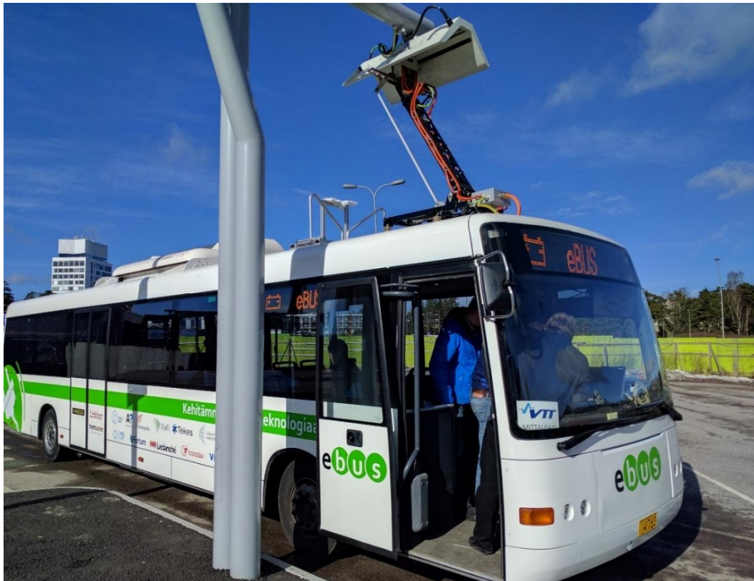
Kuva 2.21. VTT:n prototyypibussi/kehitysalusta ("eMULE") pikalataamassa Tapiolassa.
