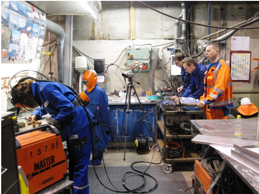
Kuva 36. Ruostumattoman teräksen hitsaustyöpiste ja ääni- sekä ilmanlaatumittajat työssään.
