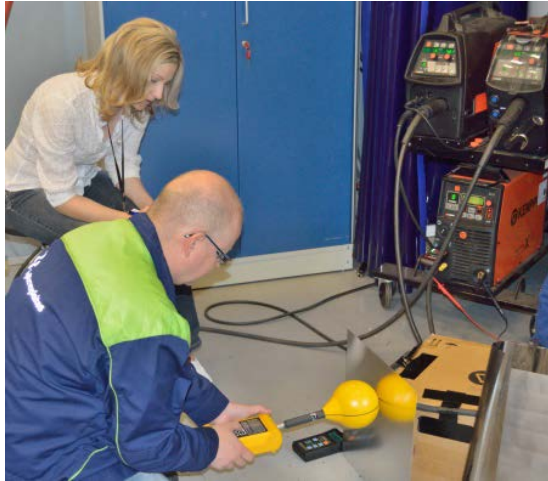
Kuva 12. Magneettikenttien mittaaminen, kun välissä on magneettikenttiä rajoittavaa materiaalia.
