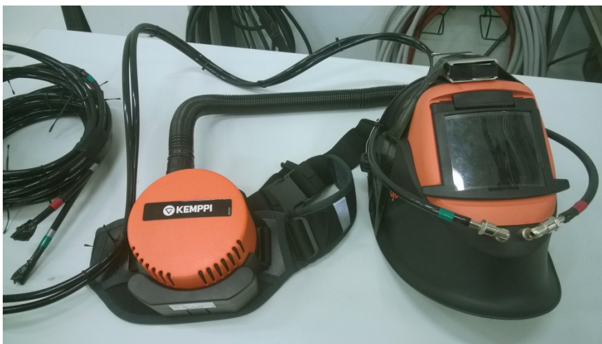
Kuva 37. Puhaltimella varustettu suodatinsuojain PAPR.
