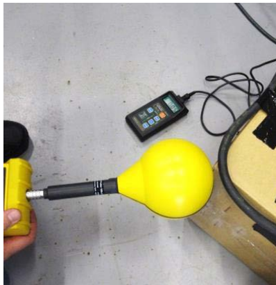
Kuva 11. Magneetikenttien mittalaite hitsausjohdon 90 ° kulman kohdalla.
