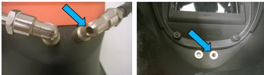
Kuva 38. Ilmanäytteenottopiste maskin ulko- ja sisäpuolelta
