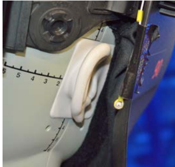
Kuva 24. Tosipäämikrofonin sijoitus hitsausmaskiin.
