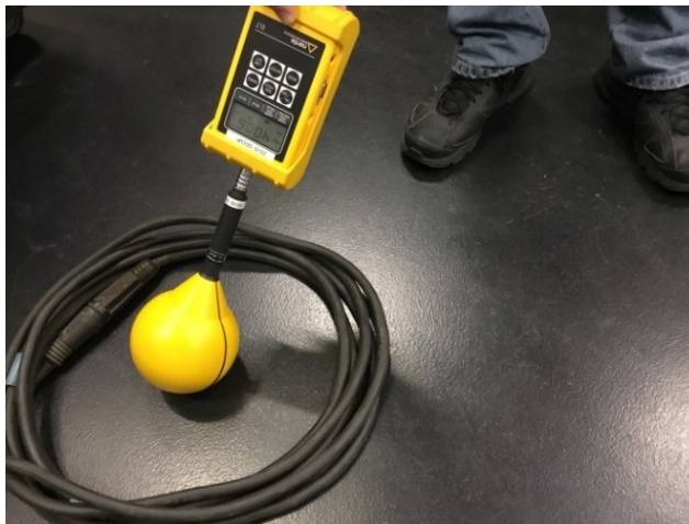
Kuva 17. Hitsausjohto on kiepillä ja magneettikenttä mitataan kiepin keskeltä.
