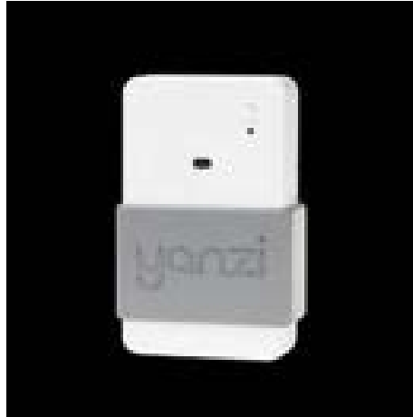
Kuva 54. Telian Yanzi- tukiasema sekä Comfort-sensorit ovat käytössä sisäilman laatua mitattaessa.
