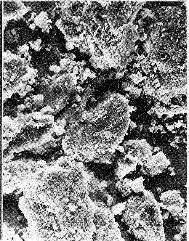
Kuva 14. SEM-kuva tiilijauheesta. Tiilijauhe-alkoholi-suspensiosta otettu tippa messinkialustalle. Suurennos 1000 x.
