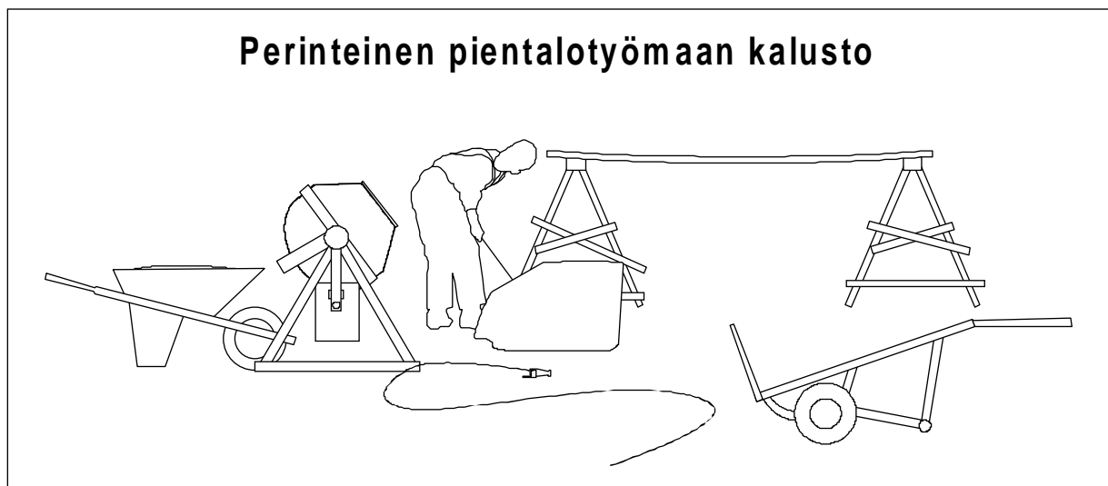
Kuva 3. Pientalotyömaan perinteinen muurauskalusto.
