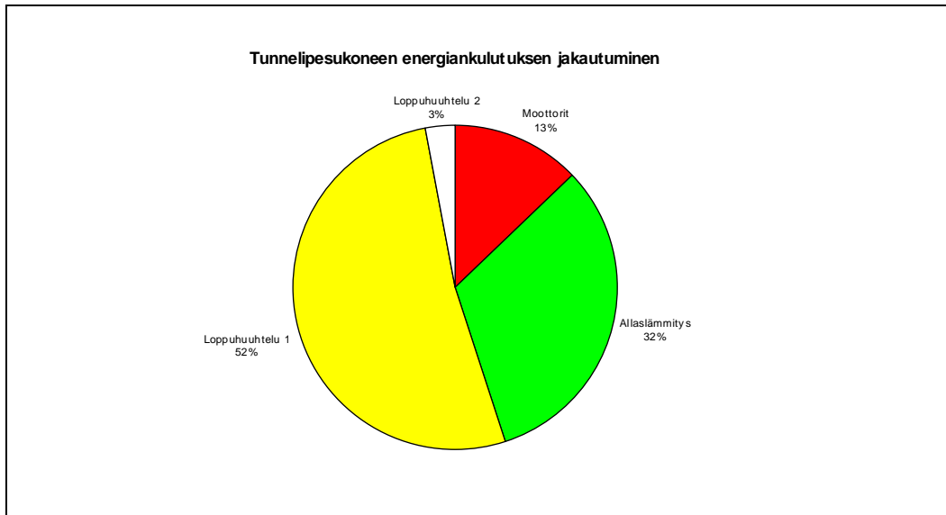
Kuva 42. Tunnelipesukoneen sähkönkulutuksen jakautuminen laitteen eri osien ja prosessin toimintojen kesken.
