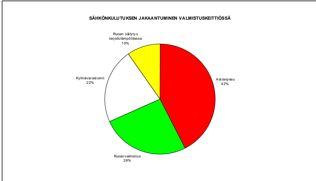
Kuva 36. Sähkönkulutuksen jakaantuminen eri toimintojen kesken mittausten mukaan eräässä valmistuskeittiössä /25/.
