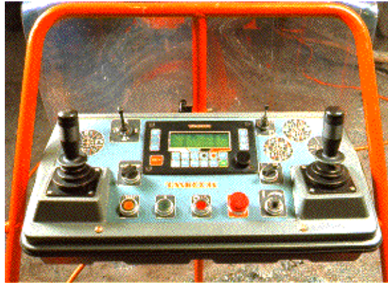
Kuva 10. Ohjauspaneeli, jossa keskellä graafinen käyttöliittymä.
