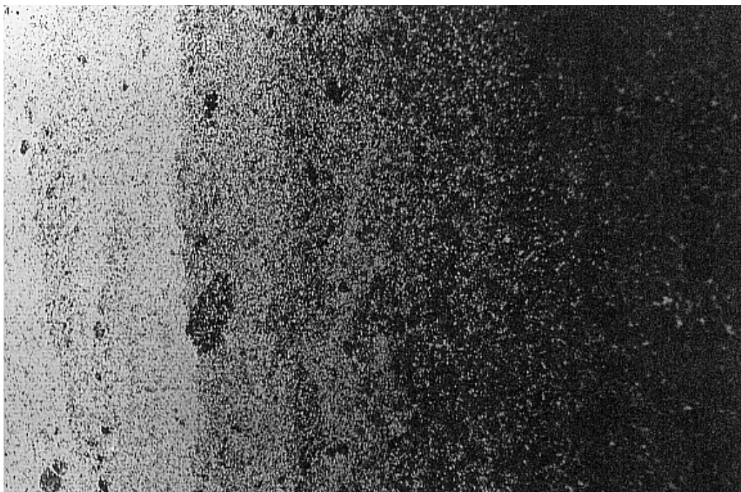
Kuva 16. Levymuotilla valmistetun kappaleen D valokuva. Muotti avattuna vasemmalla, kappale oikealla. Uloimpana ollut alumiinioksidi ei ole tiivistynyt 1250 °C:n lämpötilassa ja 100 MPa:n paineessa.
