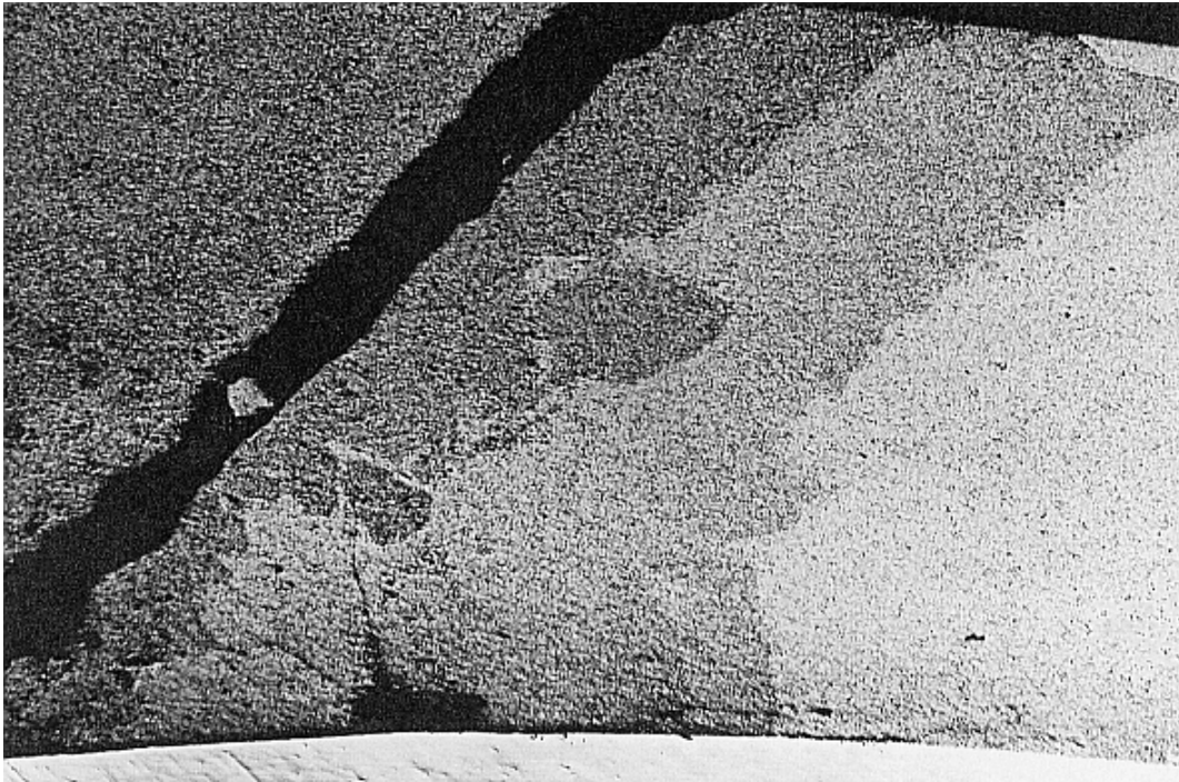
Kuva 18. Kappaleen D mikrorakennetta. Kuvasta erottuvat mustina halkeamat. Tummin alue sisältää 40 % alumiinioksidia, vaaleimmat 30 % ja 20 %. Rakenne on selvästi kerroksellinen. Kerrosten rajat ovat selviä, mutta kuitenkin rikkonaisempia kuin esimerkiksi kuvien 12 ja 13 kappaleilla. 20-kertainen suurennos.
