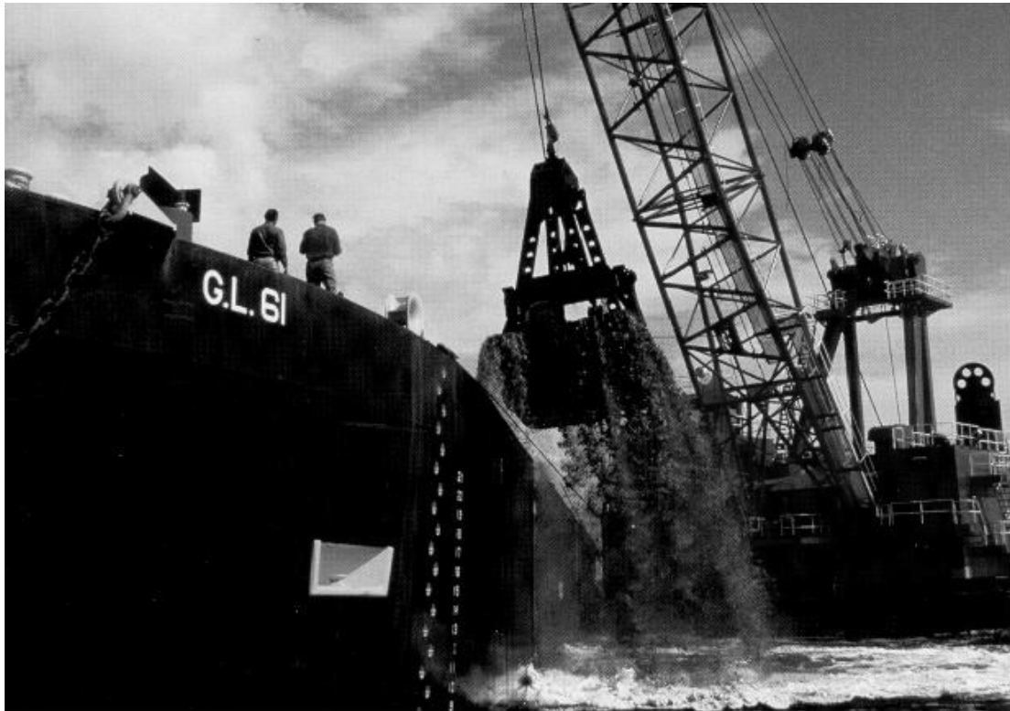
Kuva 1. Suurikokoinen kahmarikauha lastaamassa proomua Suurilla Järvillä Chicagossa. Kauhasta putoaa runsaasti materiaalia (TU Delft 1995).
