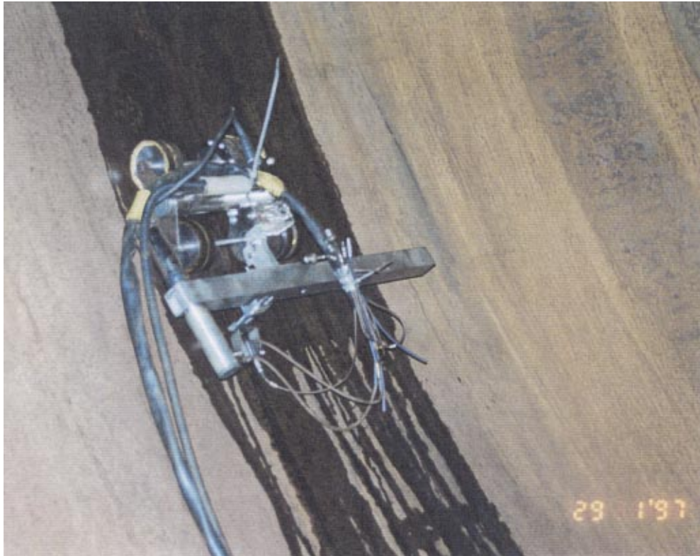
Kuva 5. VTT:n käyttämä säiliöiden testaukseen soveltuva luotausautomaatti.
