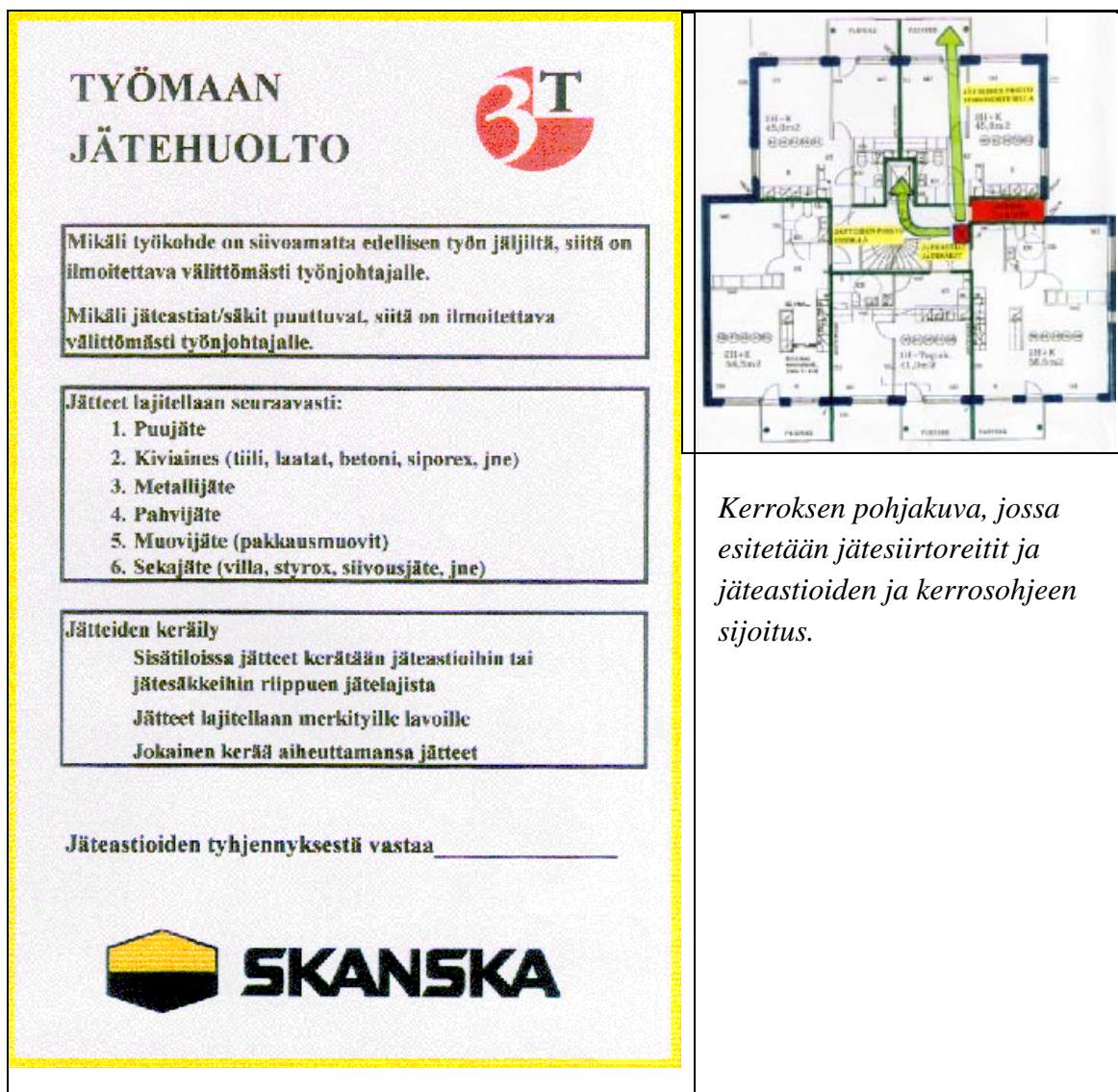
Kuva 5.21. Työmaalla oli jokaisessa kerroksessa jätehuolto-ohje -taulu, jossa esitettiin työmaan jätehuoltosuunnitelmat. Jätehuollon yleisohjeiden ja pohjakuvan lisäksi jätehuolto-ohje-taulussa esitettiin lajitteluohje työvaiheittain (ks. taulukko 5.11).
