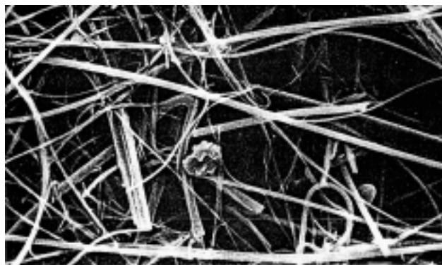
Kuva 11. Kuitusuodattimen yksittäisiä kuituja (Hinds 1982).
