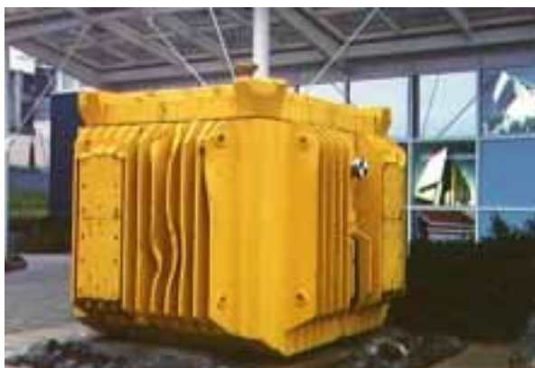
Kuva 2.4. Käytetyn ydinpolttoaineen kuljetussäiliön luonnonmukainen törmäyskoe rautateillä. Yläkuva: juna tulee vasemmalta ja keltainen kuljetussäiliö näkyy kuvassa oikealla. Alakuva: kuljetussäiliö törmäyskokeen jälkeen (BNFL 1998a, BNFL ym. 1998).
