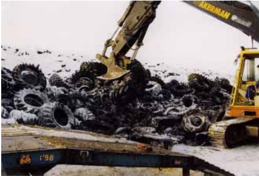
Suurikokoisten renkaiden esipilkkominen hydraulisilla saksilla.
