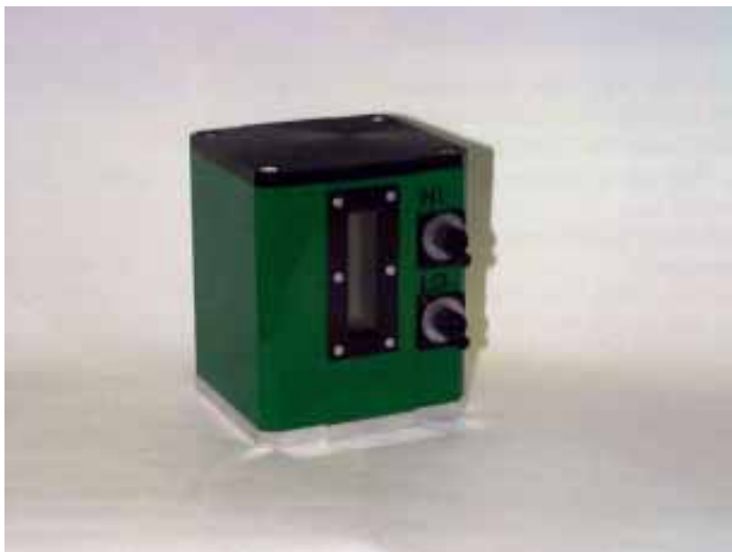
Kuva 11. Pinnan emissiviteetin mittari Emissiometer Mk II.
