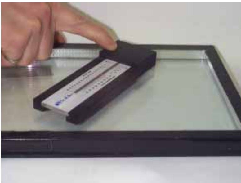
Kuva 4. Lasin paksuuden mittari (Merlin Lazer).
