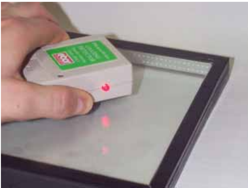
Kuva 7. Selektiivilasin tunnistamiseen tehty mittari (Pilkington).
