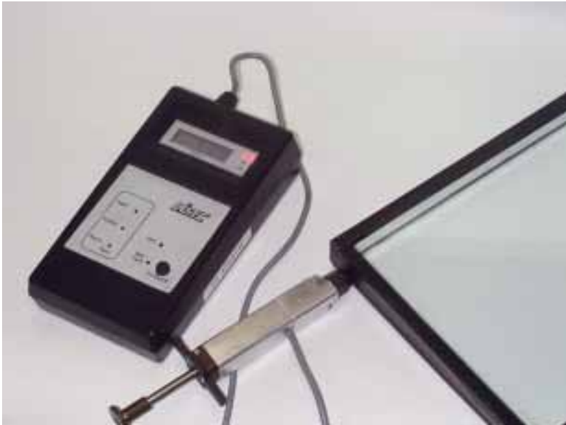
Kuva 19. Näytteenottoon perustuva kaasunpitoisuuden mittari (Lisec).
