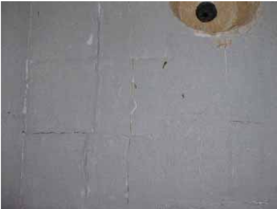
Kuva 19. Poltinseinän vasen puoli yhden korkealämpötila-ajon (1 400 °C) jälkeen. Uusi särö on syntynyt ”puolen Pyrobloc-moduulin” verran aiemmasta säröstä oikealle, seuraavaan ”särön aihioon”.
