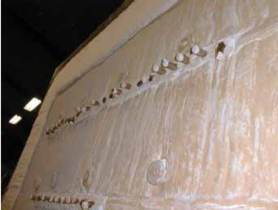
Kuva 18. Uunin luukussa ollut vastusten kiinnitystappien kokeilu. Tapit kestivät hyvin 1 300 °C:n lämpötilassa tehdyt kokeet, mutta sulivat, kun lämpötila nostettiin 1 400 °C:seen.
