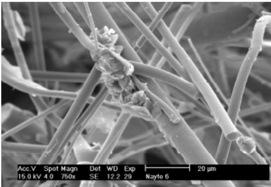
Kuva 6.2. 1 400-laadun kuitumateriaalia koeajojen jälkeen. Kuidut ovat olleen yli kaksi viikkoa n. 1 300 °C:ssa. Kuidut ovat lähes vahingoittumattoman näköisiä! Pinnassa on joitakin epätasaisia kohtia. Näitä on kuitenkin niin vähän, että esimerkiksi kiteytymisestä tai yhteensintrautumisesta ei voi tehdä johtopäätöksiä (vertailukohteita esim. kuvat 1.2, 2.2 ja 3.2). 1 000-kertainen suurennos.
