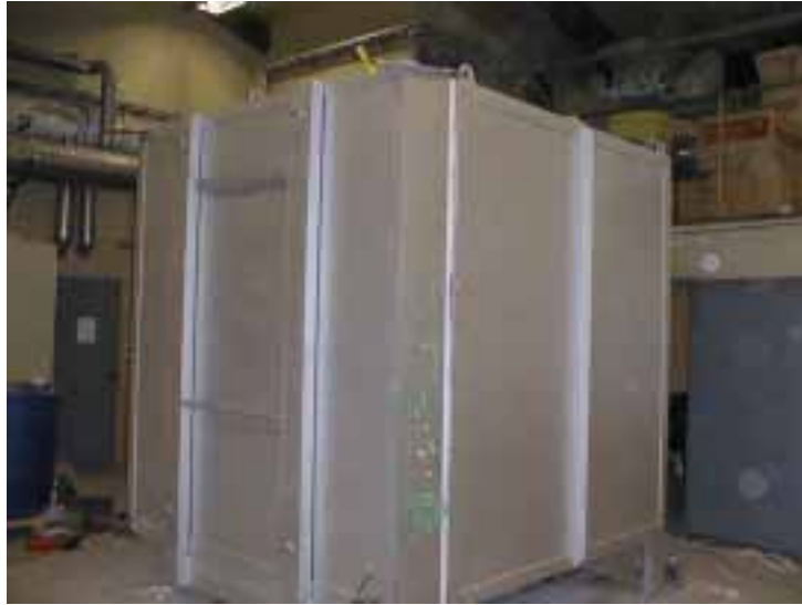
Kuva 1. Koeuuni ulkoapäin, oikea seinä ja luukkuseinä.
