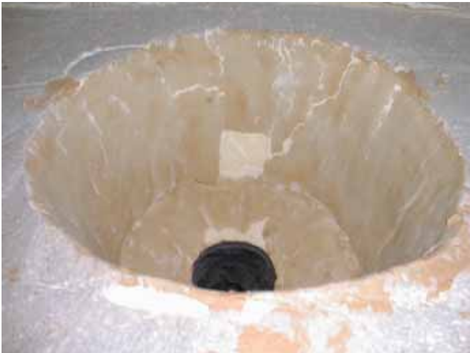
Kuva 15. Poltinkartio kahden viikon koeajojen jälkeen. Pinnoite on paikoin lohkeillut.
