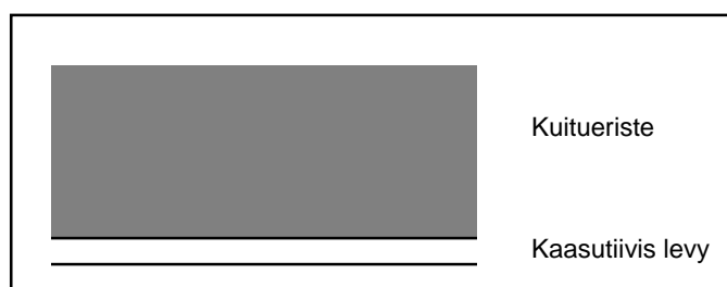
Kuva 63. Kuiturakenteinen mahdollinen seinämärakenne.
