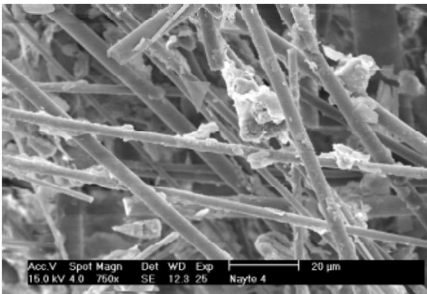
Kuva 4.2. Ceraboard-levy toimitustilaisena. Suurimmaksi osaksi sileäpintaisia kuituja, mutta seassa on myös melkoisesti ilmeisesti sideaineesta johtuvia epäsäännöllisiä muodostumia. 1 000-kertainen suurennos.
