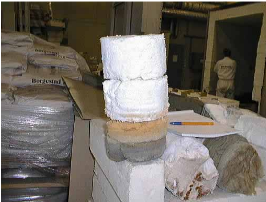
Kuva 17. Seinistä otettuja näytteitä. Pystyssä luukusta otettu näyte, josta näkyy HT900-levyn värin muuttuminen korkean lämpötilan vaikutuksesta.
