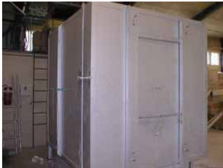
Kuva 2. Koeuuni ulkoapäin, vasen seinä ja luukkuseinä.
