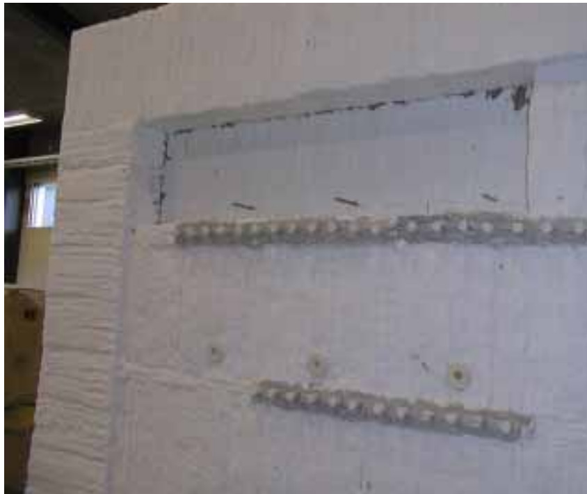
Kuva 11. Luukun yläosaa, sähkövastusten kiinnitysjärjestelmä.
