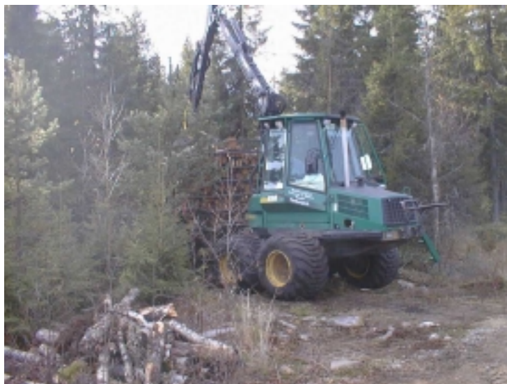
Kuva 19. Kevyempi metsätyökone, kuten kuormatraktori kuvassa, vaurioittaa vähemmän maapohjaa (Timberjack).
