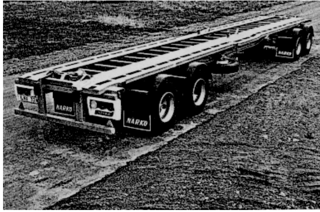
Kuva 13. Lavaperävaunun runkorakenne (Närko).
