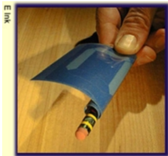
Kuva 12. Uusilla näyttötekniikoilla on valmistettavissa erittäin keveitä ja taipuisia näyttöjä.
