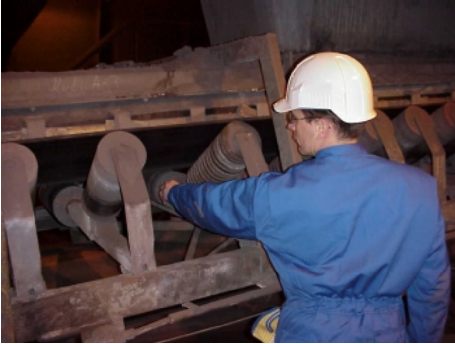
Kuva 16. Kuljettimen runkorakenteen pystytolppa lisää kannatusrullan ja hihnan muodostaman nielun vaarallisuutta, koska se estää käden kiertymisen rullan kannattimen yli.
