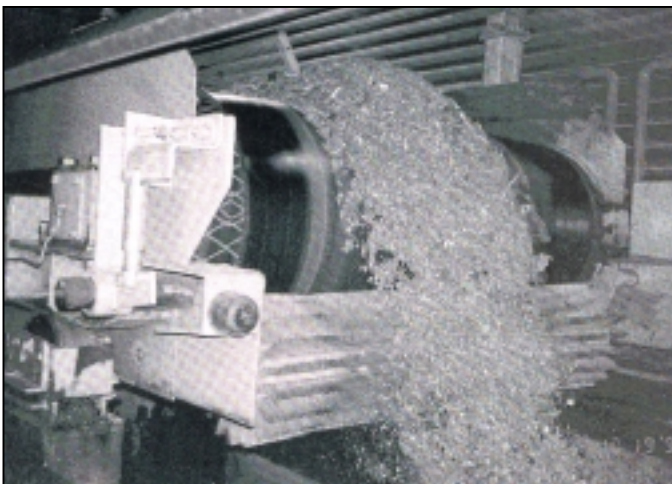
Kuva 7. Hihnakuuljettimen purkauspään hihnaharja [10].
