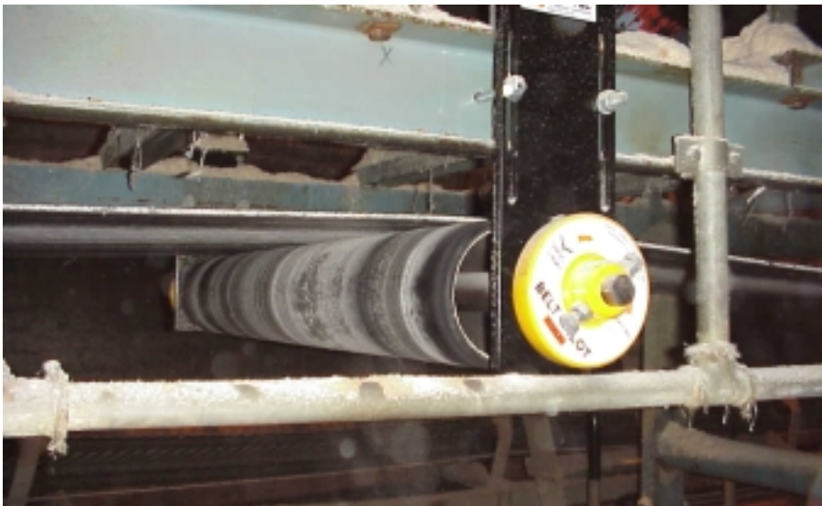
Kuva 26. Hihnan keskittämistä parantava ohjausrulla.
