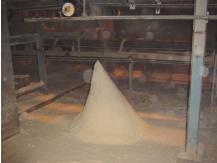
Kuva 27. Kaavarien puuttellisen toiminnan aiheuttamaa karistetta kuljettimen alla.
