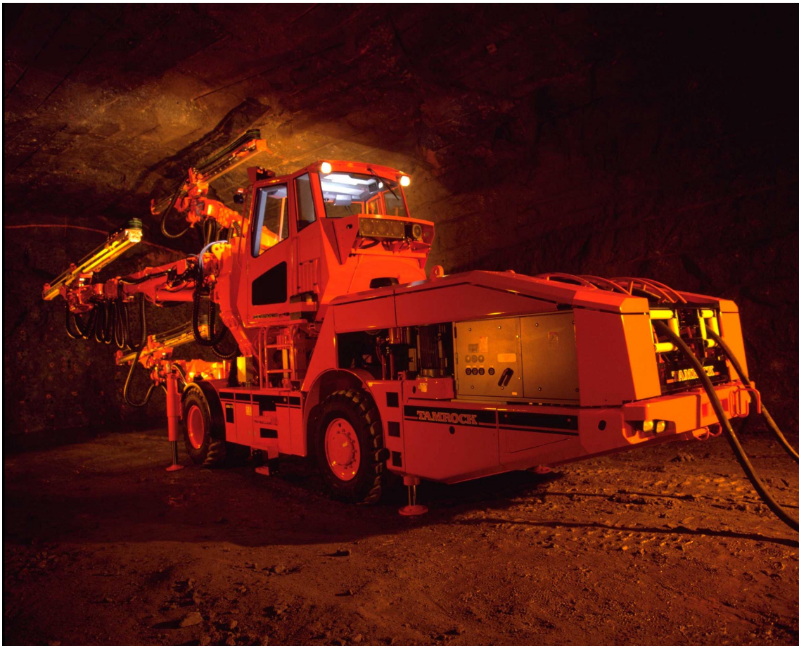
Kuva 1. Luotettavuusjohtamisjärjestelmästandardien soveltuvuutta työkoneteollisuuteen tutkittiin projektin aikana mm. Sandvik Tamrock Oy:n kanssa. Kuvassa Tamrock Axera T -porajumbo.
