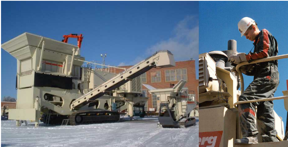
Kuva 11. Nordberg-Lokomo on testannut värähtelymittausten toimivuutta liikkuvien murskauslaitosten kunnonvalvonnassa. Kuvassa Nordbergin suurin (LT160) sekä pienin (CC63) tela-alustainen murskauslaitos. Oikealla kehitysinsinööri Juhamatti Heikkilä suorittamassa kunnonvalvontamittausta.
