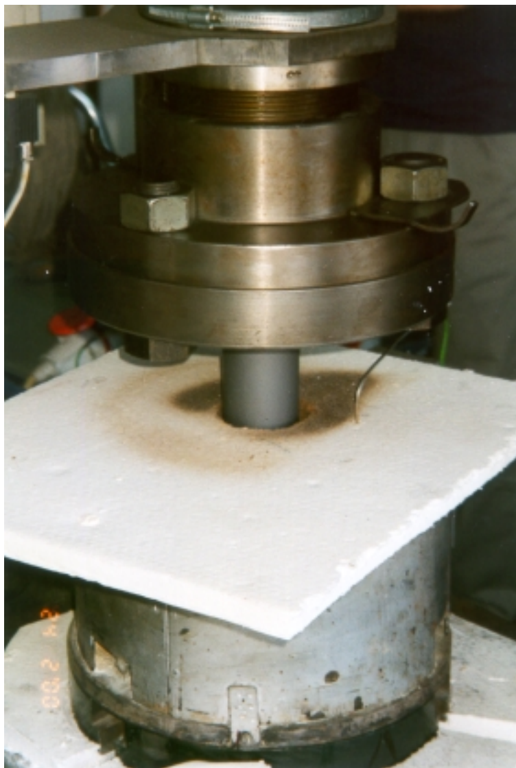
Kuva 18. RPC:n valmistusta kuumapuristimella.
