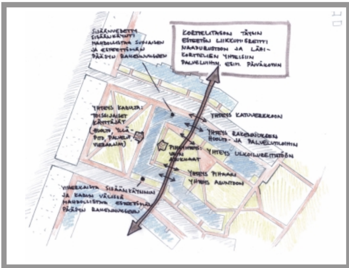
Kuva 2.1. Korttelin sisäinen esteetön liikkumisreitti tarjoaa yhteyden kodista mm. peruspalveluihin, yhteistiloihin, huoltotiloihin ja liikennevälineisiin. Huolto ja kunnossapito tapahtuvat kadun puolelta piha-alueen rauhaa häiritsemättä.
