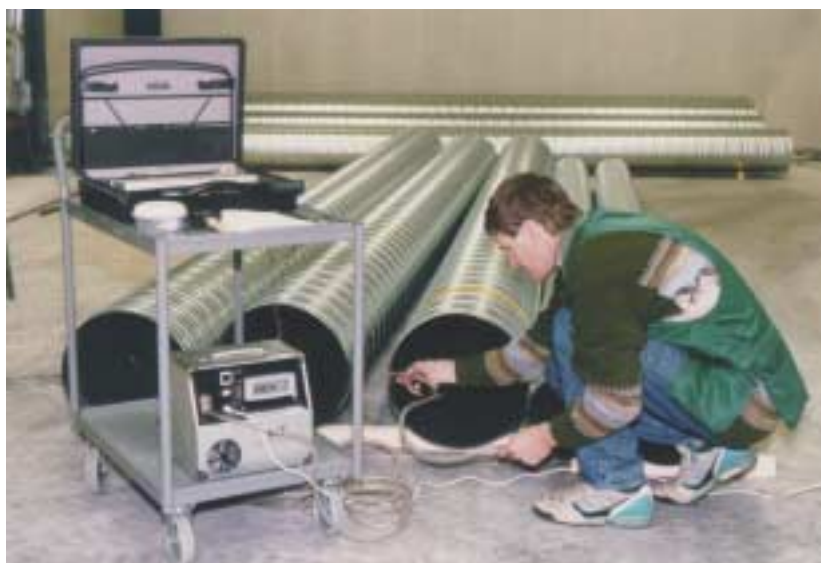
Kuva 1. Tehtaalla olevien ilmanvaihtokanavien sisäpuolisen pölykertymän määrittystä varten pöly imettiin halutulta pinta-alalta suodatinkoteloon.
