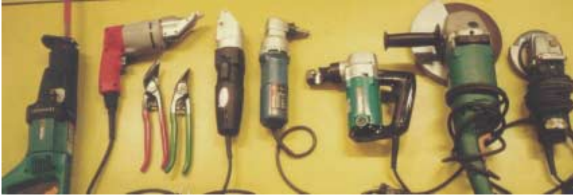
Kuva 9. Testatut työkalut. Kuvassa vasemmalta lukien Makitan puukkosaha, Milwaukeeen sähkökäyttöiset peltisakset, Bahcon peltisakset, Dräcon levyleikkuri, Boschin nakertaja, Makitan nakertaja, Makitan kulmahiomakone ja Metabon kulmahiomakone.
