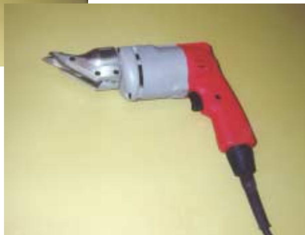
Kuvat 15a ja 15b. Dräcon levyleikkurin ja Milwaukeeen sähkökäyttöisten peltisaksien käyttöominaisuuksia testattiin sairaalan laajennustyömaalla.
