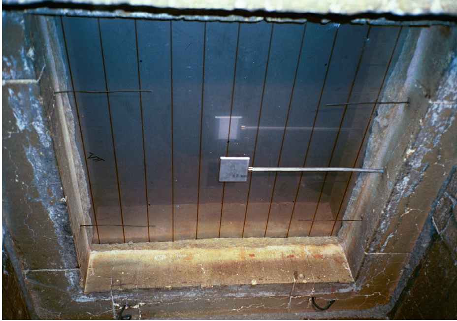
Kuva 14. Koekappale asennettuna kuutiouuniin.
