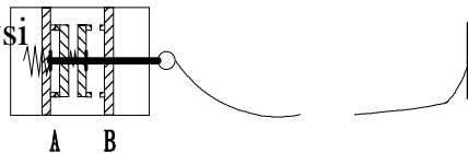
Kuva 6. Erään köysihätäpysäyttimen toimintaperiaate.
