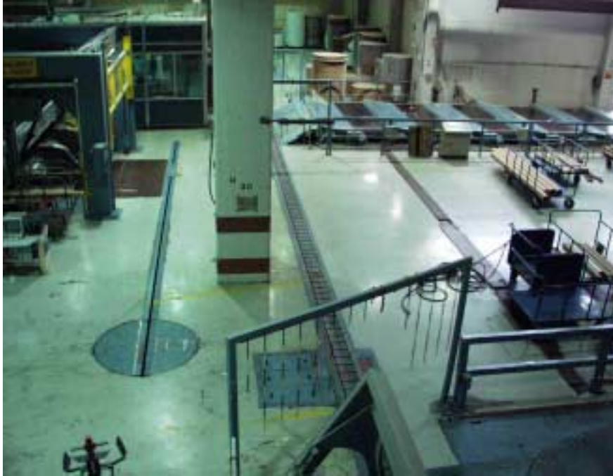
Kuva 9. Kuljettimen läheisyydessä olevan rakenteen aiheuttama puristumiskohta.
