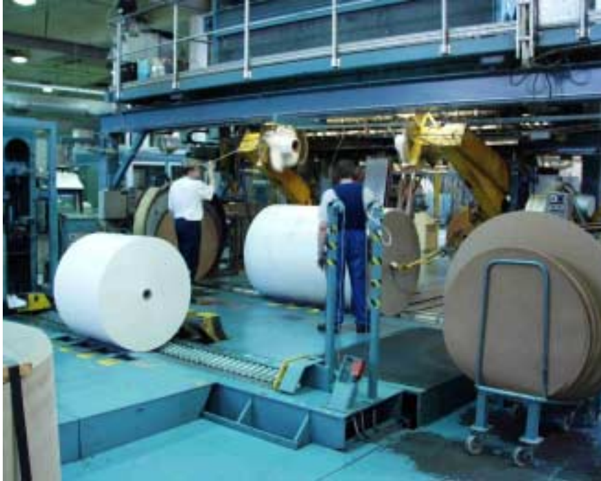
Kuva 14. Pakkauskoneen toimintajakson käynnistäminen käynnistysvaijerista.
