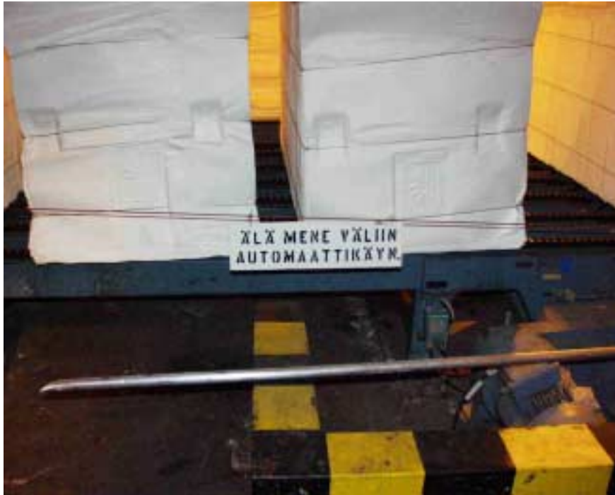
Kuva 15. Kuljettimien ja paalien väliin muodostuvia puristumiskohtia.
