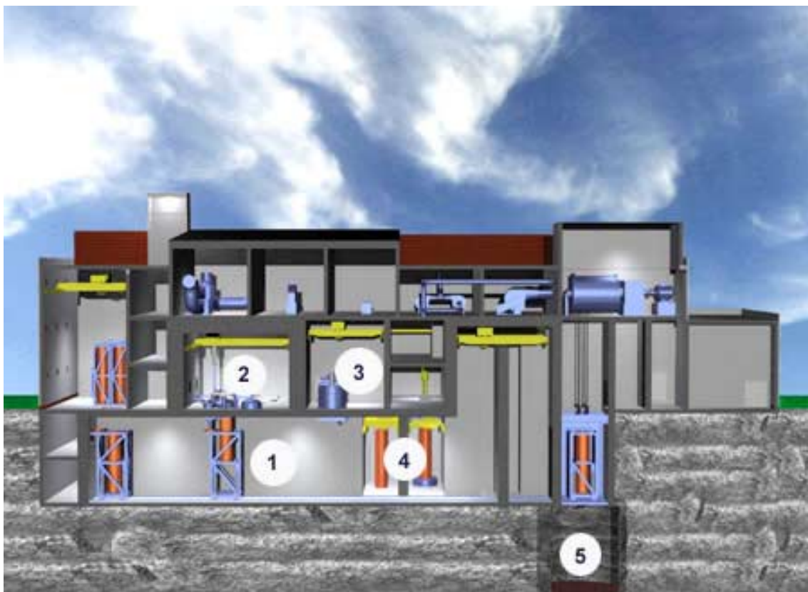
Kuva 14. Käytetyn ydinpolttoaineen käsittelyn vaiheet kapselointilaitoksella: 1) kapselin telakoiminen kuumakammioon, 2) polttoainenäppujen siirtäminen kuljetussäiliöstä kapseliin, 3) kapselin kannen hitsaaminen, 4) kapselin tarkastus, 5) loppusijoituskapselin laskeminen hissillä loppusijoitustiloihin noin 500 m:n syvyyteen (muokattu viitteen Kukkola 1999b pohjalta).
