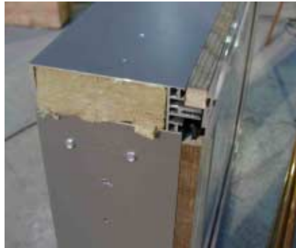
Kuva F1. Palokokeissa käytetty koekappale. Alumiiniprofiilin avoimet päät täytettiin palovillalla ennen koetta. Nuolet osoittavat lämpötilojen T1 ja T2 mittauskohdat profiilin sivun keskellä. Mittaukset T5 ja T6 sijaitsivat vastaavissa kohdissa lasin ja kehyksen liitoskohdassa 5 mm kehyksen sisällä. Kehyksessä on palavina materiaaleina puurimoja sekä kumitiivisteitä.
