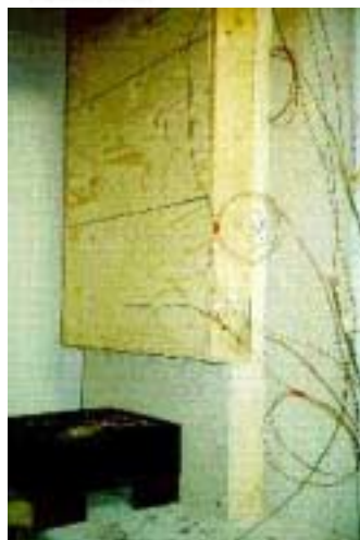
Kuva 32. a) Julkisivuontelokoekappaleiden rakenne ja b) polttimen sijoittelu.
