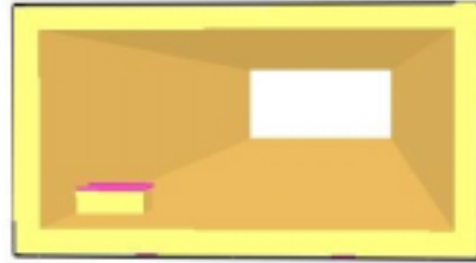
Kuva 44. Vaakasuorien ontelotilojen mallinnuksessa tutkitut kaksi palokuorman sijainniltaan erilaista tapausta: a) palokuorma on selvästi erillään tilan reunoista ja b) palokuorma on tilan verhoiluna.
