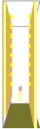
Kuva 68. Asetelma, jossa tutkittiin pystysuuntaisen ontelotilan syvyyden vaikutusta tilassa kehittyvään paloon: kaksi lähekkäin olevaa palavaa seinää sytytetään niiden keskellä olevalla lämmönlähteellä (teho 23 kW). Systeemiin tulee ilmaa vasemman seinän alaosassa olevan aukon kautta.
