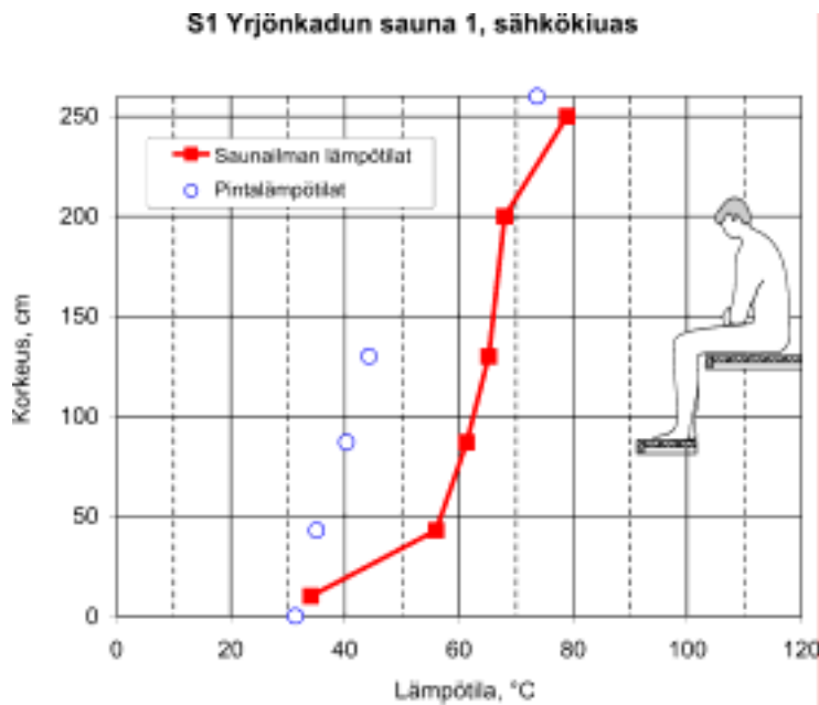
Kuva 17. Kaakelilauteisessa saunassa S1 ilman lämpötilajakauma oli lähes optimaalinen, mutta lämpötilataso oli liian matala. Syynä oli kiuastehon riittämättömyys. Tehontarvetta lisäsivät kaakelilauteet ja liian suuri poistoilmavirta. Kaakelilauteiden pintalämpötila oli noin 20 °C ilmaa viileämpi.
