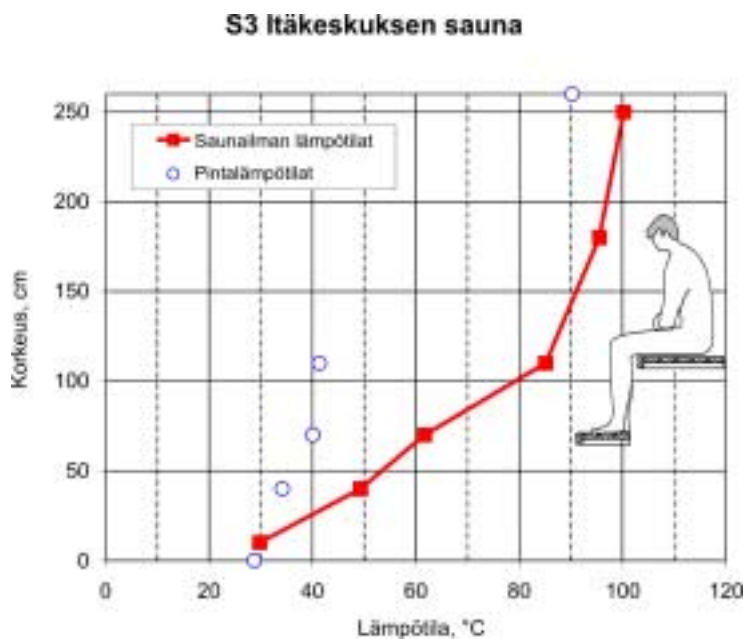
Kuva 19. Kaakelilauteisessa saunassa S3 ilman lämpötilajakauma oli hyvin epätasainen ja lämpötila oli korkea pään korkeudella. Saunan alaosan viileys selittyy kaakelipintojen suurella määrällä ja ilman sekoittumista heikentävillä umpikaiteilla. Kaakelilauteiden pintalämpötila on jopa 40 °C ilmaa viileämpi.
