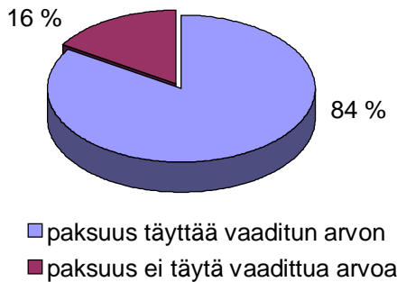
Kuva 22. Ruiskubetonin paksuus seinä- osuuksilla mitatuissa pisteissä, yhteensä 68 kpl.
