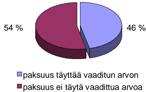
Kuva 23. Ruiskubetonin paksuus holvi- osuuksilla mitatuissa pisteissä, yhteensä 110 kpl.
