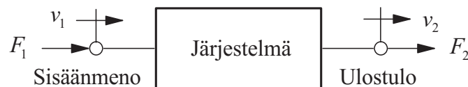
Kuva 11. Yleinen nelinapajärjestelmä, jonka sisäänmenon ja ulostulon voimien ja nopeuksien positiiviset suunnat ovat kuvan mukaiset [19].
