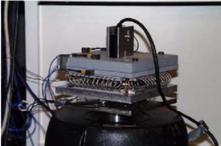
Kuva 4. Epäsuoran menetelmän mukainen koejärjestely vaijeritärinäeristimen dynaamisten ominaisuuksien määrittämiseksi, kun staattinen kuormitusmassa on 5,8 kg [6].
