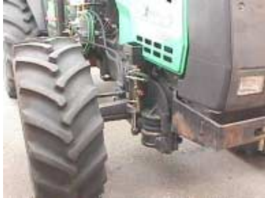
Kuva 5.3.17. Traktoriin asennettu hydropneumaattinen puoliaktiivinen elementti ja venttiililohko.
