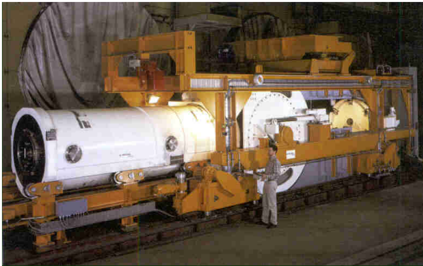
Kuva 5. SKB:n kehittämä kauko-ohjatun ja säteilysuojatun kapseliauton prototyyppi (Witherspoon & Bodvarsson 2001).
