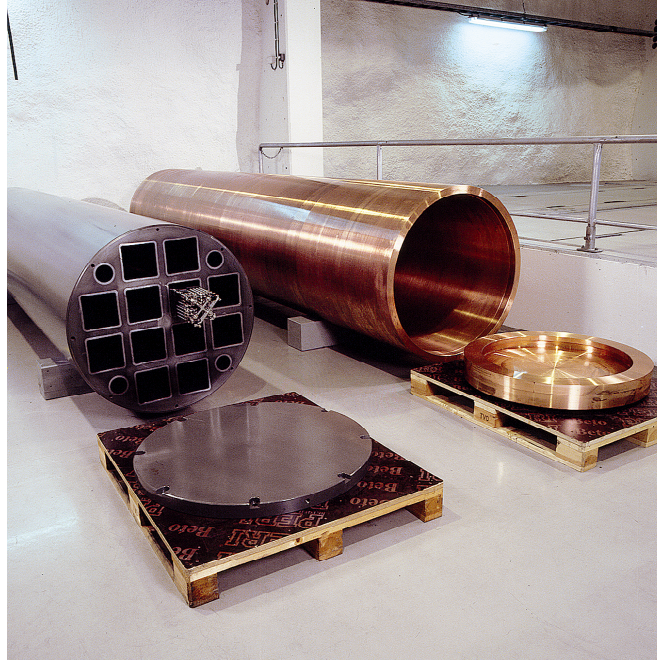
Kuva 3. Loppusijoituskapseli. Sisemmässä kapselissa (kuvassa vasemmalla) on paikat polttoainenipuille. Ulompi kapseli (kuvassa oikealla) toimii korroosiosuojana (www.posiva.fi/kuvat 25.6.2002).
