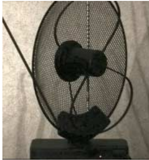
Kuva 2. Pöytäantenni, jolla digisignaalia voitiin vastaanottaa kohtuullisin tuloksin.
