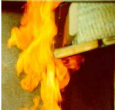
Kuva A17. Räystäskokeen 3 aikana ei havaittu hormi-ilmiötä: a) kuva 4 minuuttia ja b) kuva 17 minuuttia polttimen sytyttämisen jälkeen.
