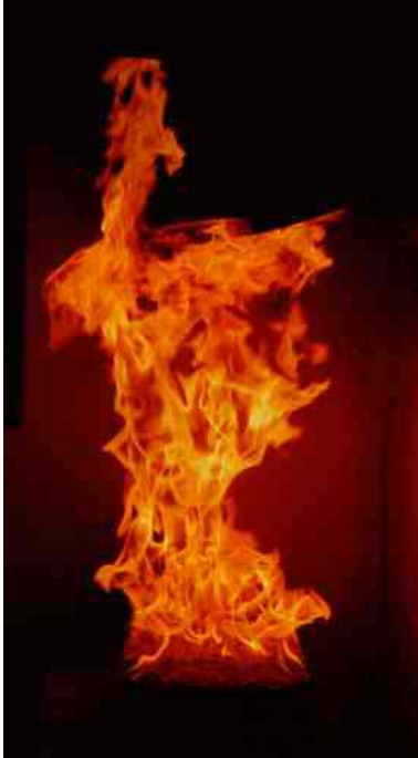
Kuva A30. Voimakkaasta palamisesta huolimatta liekit eivät menneet sisään räystäs- koekappaleen 5 tuuletusaukosta: a) 1:00 ja b) 14:00 polttimen sytyttämisen jälkeen.
