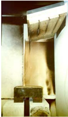
Kuva A4. Räystä 1, kojärjestelyt: a) kaaviokuva edestä ja b) kaaviokuva sivulta. c) valokuva ennen koetta ja d) valokuva kokeen aikana 3 minuuttia polttimen sytyttämisen jälkeen (liekit ylettyvät räystäään yli).
