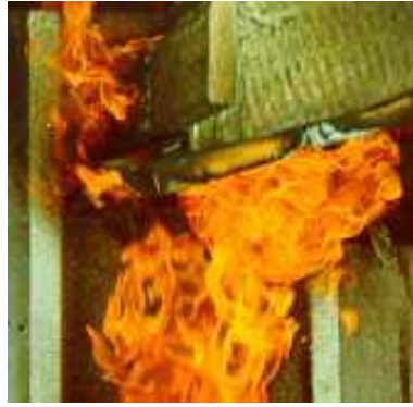
Kuva A17. Räystäskokeen 3 aikana ei havaittu hormi-ilmiötä: a) kuva 4 minuuttia ja b) kuva 17 minuuttia polttimen sytyttämisen jälkeen.
