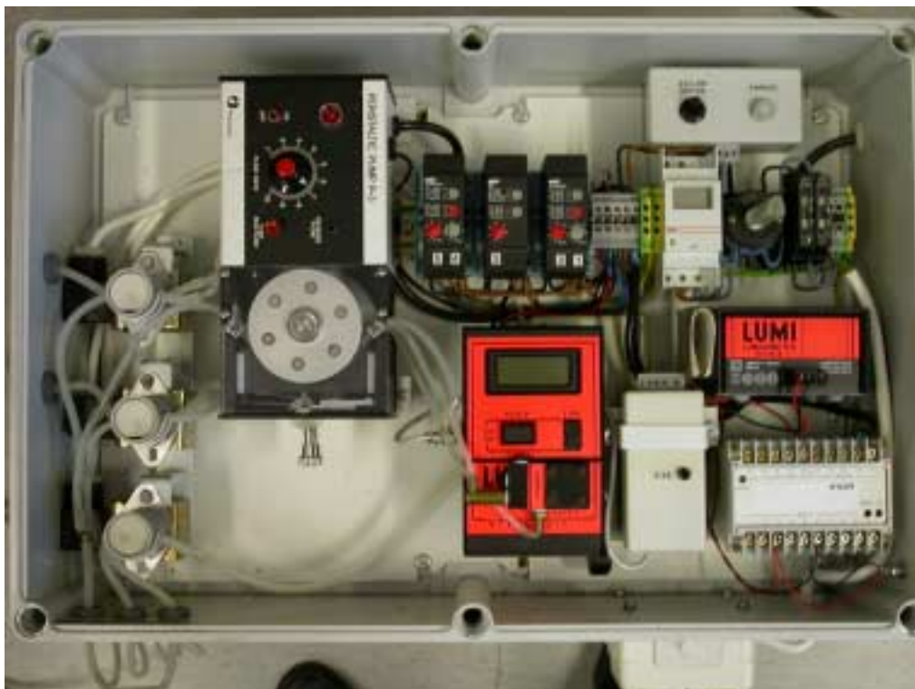
Kuva 12. VTT:n on-line ATP-bioluminisenssiin perustuva analysaattori.
