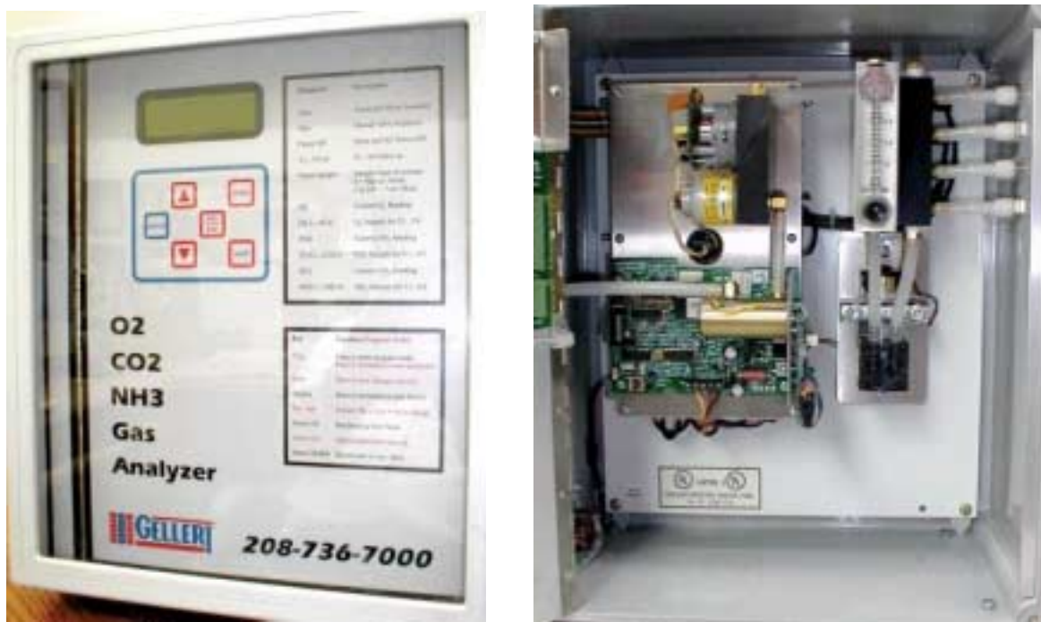
Kuva 17. Gellertin kombinoitu O 2 /CO 2 /NH 3 -kaasuanalyysaattori.
