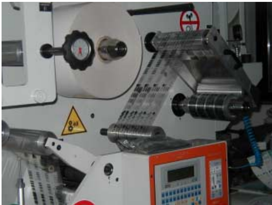
Kuva 4.5. VTT Elektronikan PICO-painokone optiikan ja elektronikan rullalta-rullalle-valmistukseen.
