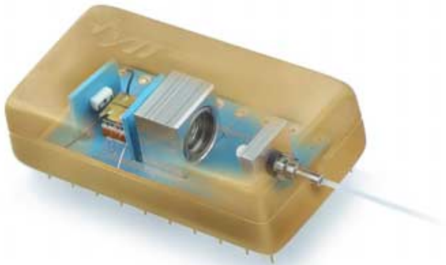
Kuva 6.5. Säädettävän laserin sisältävä optinen moduuli.
