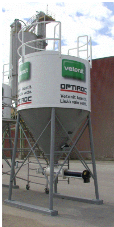
Kuva 25. Täytettävä työmaasiilo, jossa on komposiittimuovista valmistettu ruuvipumppu laastin sekoitukseen. Siilon kapasiteetti on 14 tonnia.
