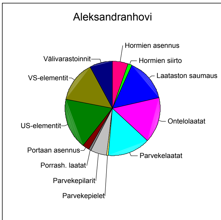
Kuva 15. Elementtityön keston jakautuminen eri työvaiheisiin ensimmäisellä mallinnustyömaalla. Huom. Osa työvaiheista voi olla yhtä aikaa käynnissä.
