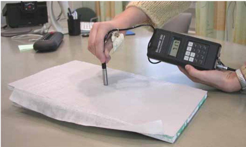
Kuva 7. Kalvopaksuuden mittaaminen pinnoitepaksuusmittarilla. Mittarin käyttö edellyttää metallipalasan asentamista vedeneristeen alle.
