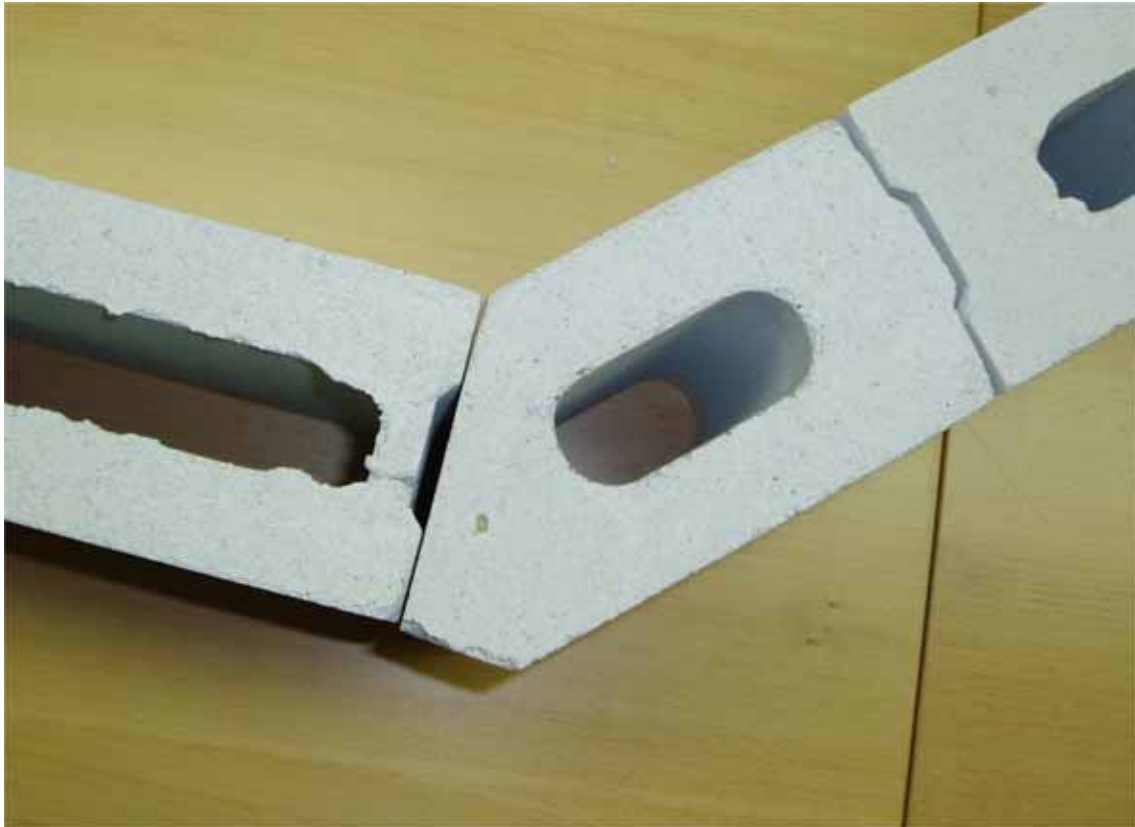
Kuva 6. Tehdasolosuhteissa sahaamalla valmistettu viisteharkko.
